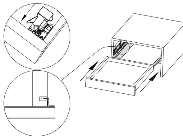
4. Регулировка фасада по вертикали. Поворачивая регулировочное колесо, отрегулируйте фасад по высоте.
