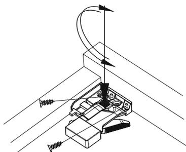
5. Демонтаж ящика. Нажмите одновременно на рычажки фиксаторов и снимите ящик с направляющих.
