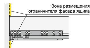
При проектировании вкладных ящиков необходимо создание опорных площадок для упора фасада (опорные площадки должны выполнять функцию боковой стенки в варианте накладного фасада). Опорные площадки предназначены обеспечивать нахождение плоскости фасада в вертикальном положении.
